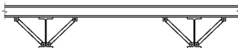
Рисунок 6.5 — Типовое жесткое закрепление от кручения
